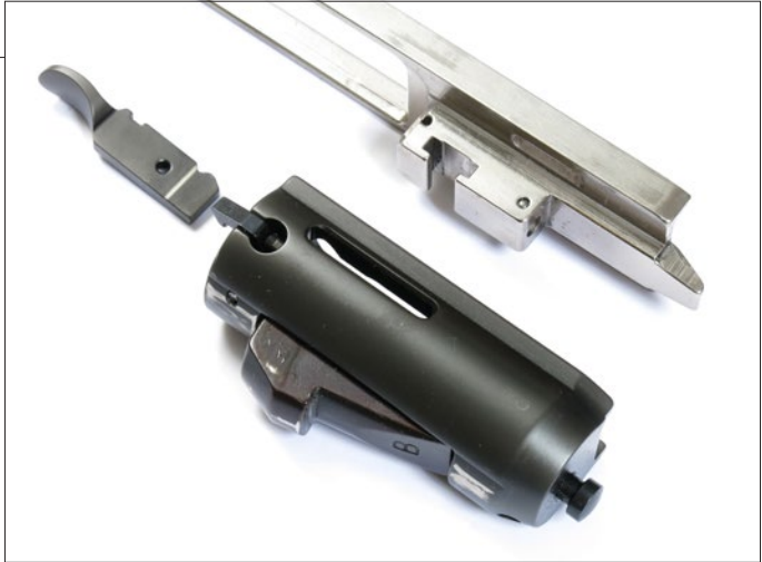
Gladiusen nousevaan harkkoon perustuva lukko on todella yksinkertainen ja tuttu monesta pumppuhaukista, joissa se on osoittautunut kestäväksi ja toimivaksi.
