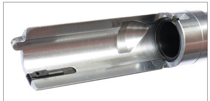
Lukon ylösnouseva harkko lukittuu piipunjatkeen katossa olevaan koloon. Hylsynkannan törmätessä ulosheittimeen se pääsee jousitettuna peräytymään, minkä pitäisi parantaa toimintavarmuutta käytettäessä eritehoisia patruunoita.
