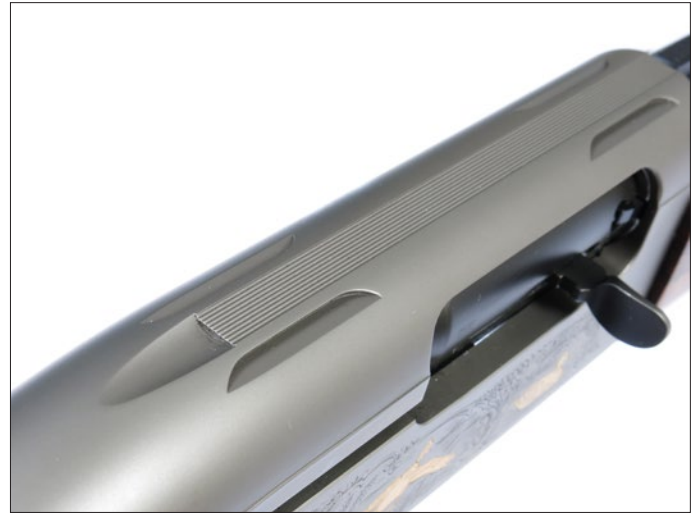
Nikkelillä mattaharmaaksi käsitellyn alumiinikehysen päällä on valmiit koneistukset optisen tähtäimen kiinnittämistä varten.
