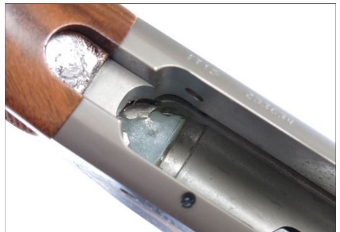
Lukon peräytymisliikkeen pysäyttää pehmeän hallitusti viimeistään suuri muovinen iskunvaimennin.
