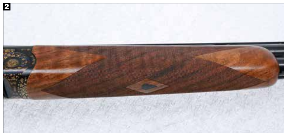
1. Lo Julia Syren con canne da 760 millimetri è lungo complessivamente 1.200 millimetri e pesa 3.700 grammi. 2. L'asta è tonda, leggermente schiacciata sui due lati e facile da impugnare. Lo sgancio è a pompa, con il tasto collocato sul puntale. 3. Il calciolo è in gomma piena e ammortizzante, spesso 12 millimetri, e regala una sensazione di rinculo piuttosto morbida sia con le cartucce da 24 sia con quelle da 28 grammi.
